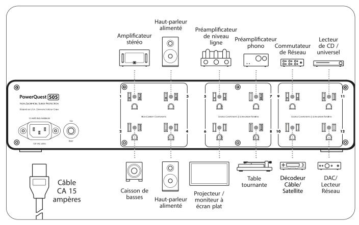
**Remarque :** les prises 5 à 12 sont soumises à de nombreuses variables et conditions de circuit, l'expérimentation est donc encouragée pour obtenir les meilleurs résultats possibles. Les amplificateurs de puissance doivent être connectés aux prises 1 à 4.
