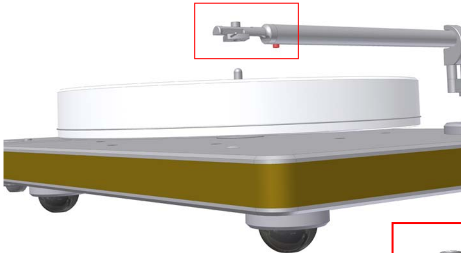
Bild 6: Veränderung des Azimuth
